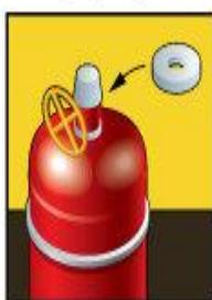
Прокладку между краном баллона и регулятором менять при каждой новой установке
