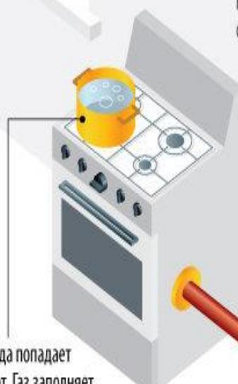
От долгой или неправильной эксплуатации происходит разрыв шланга, соединяющего газовую магистраль с плитой. Газ постепенно заполняет помещение. Искра – взрыв
