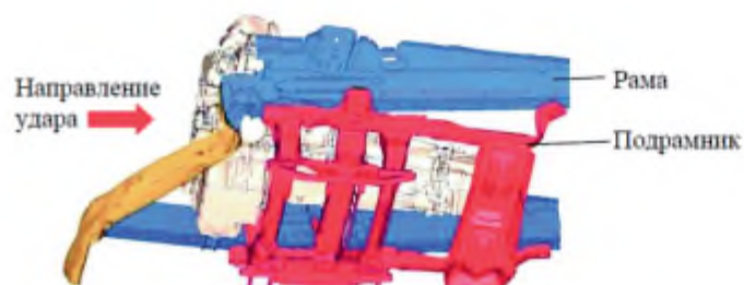
Отсоединяемый подрамник Volkswagen Crafter (вид снизу слева)
