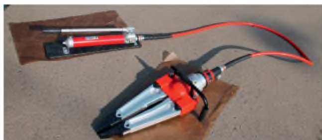
Пример соединения ручного насоса с расширителем
