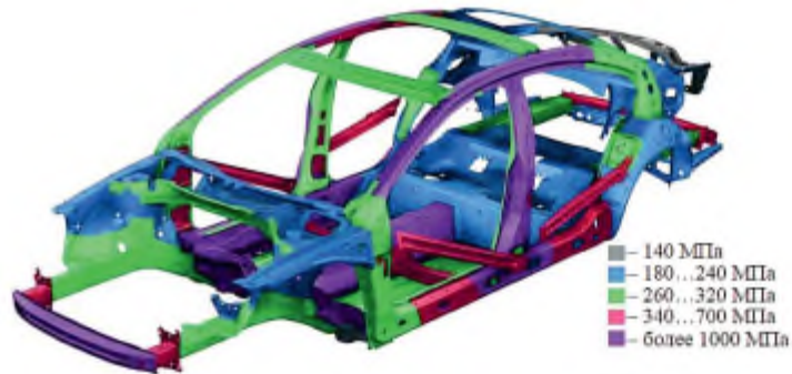
Предел прочности различных элементов силовой структуры кузова Volkswagen Passat CC
