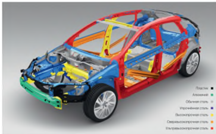
Распределение материалов, используемых в структуре кузова автомобиля
