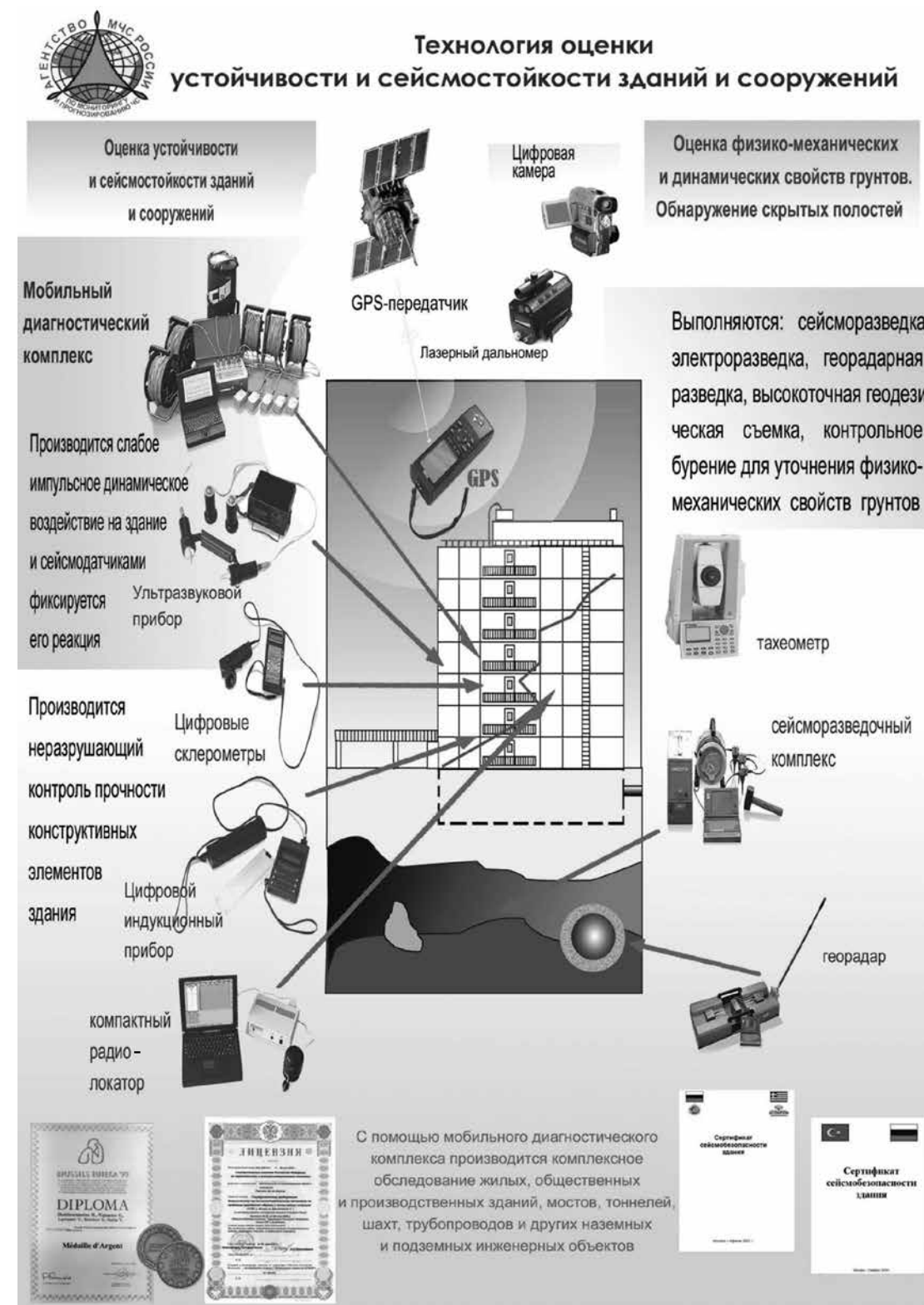
Рис. М3. Технология оценки устойчивости системы «грунт-здание»
