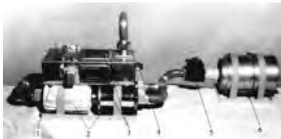
Установка «Скорость» для проведения экспериментов по изучению процесса горения материалов в условиях невесомости на космической станции «Мир»
